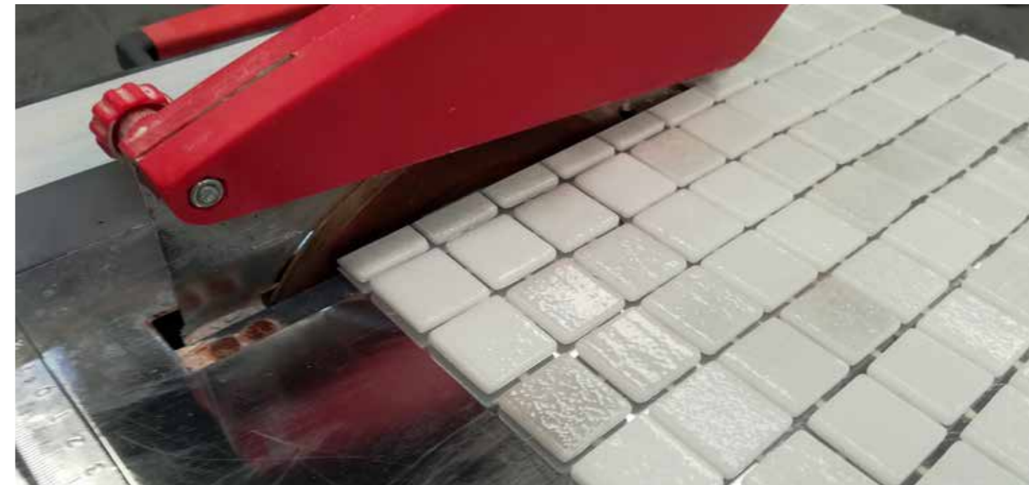
Disco de diamante para corte de Gres Porcelánico. Diamond disc for cutting of Porcelain Stoneware. Disque diamant pour la coupe de grès cérame.
